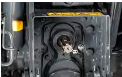
ZAPFWELLE Zapfwelle mit zwei Drehzahlbereichen, 540/540E und Standard.
